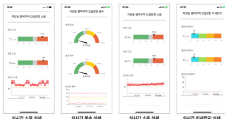
현장 풍속, 소음, 비산먼지 통합 측정 화면
